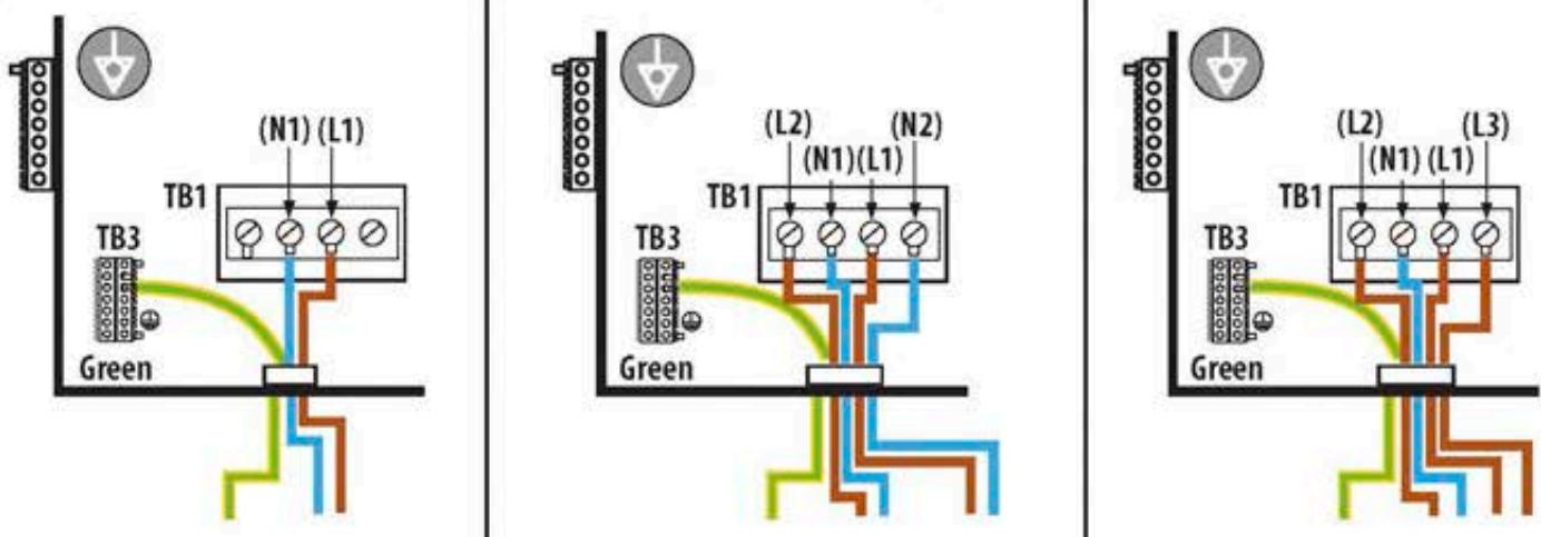
dimensionare in base all'assorbimento di corrente (massimo o alternativo) / size based on current absorption (maximum or alternative)
